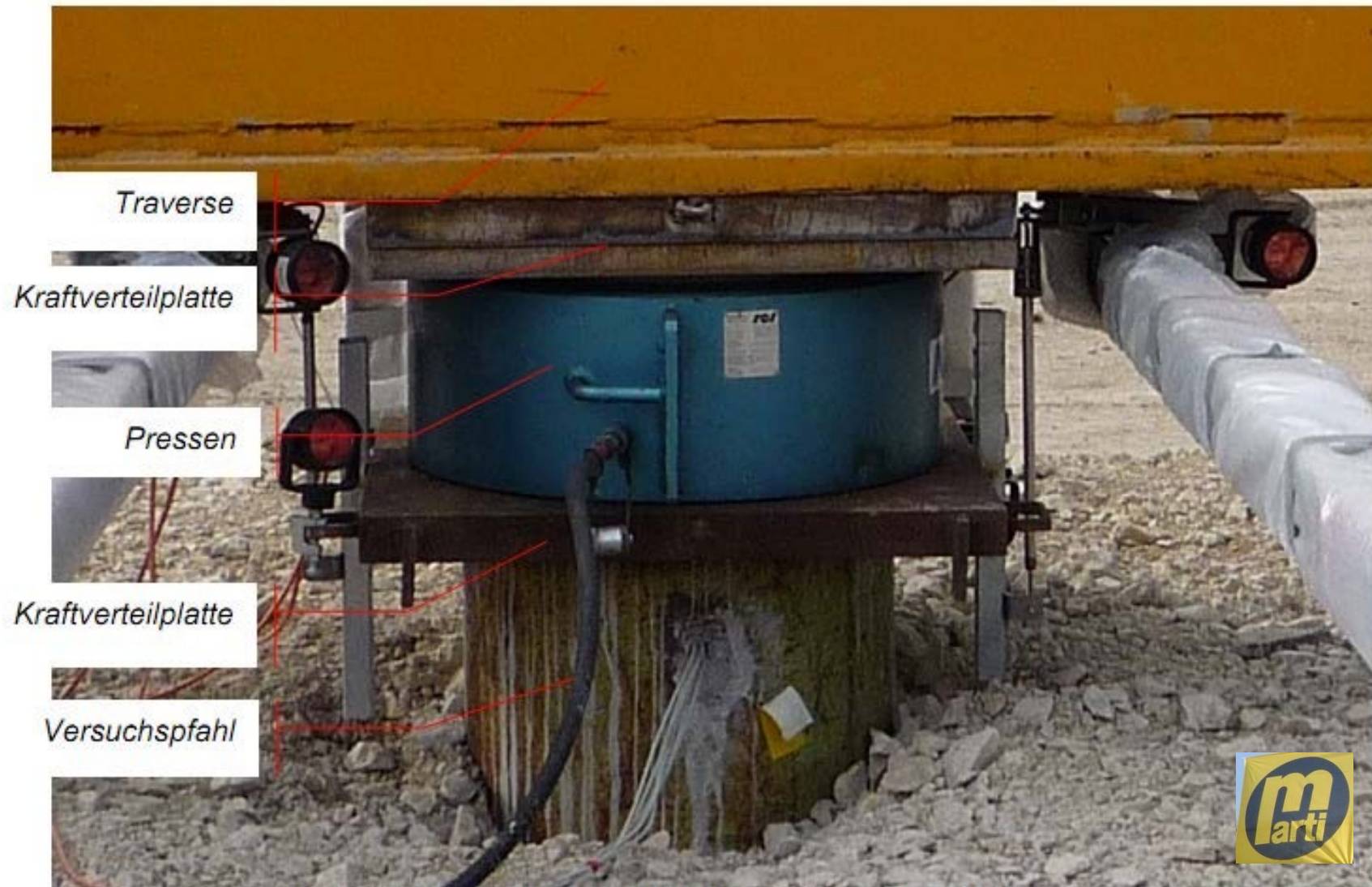
Ansicht der Belastungseinrichtung am Versuchspfahl, Pressen
